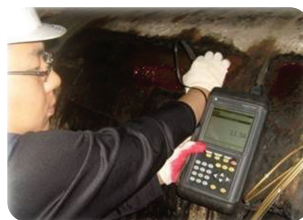
배관 두께 측정 : \pm 0.1\text{mm}
