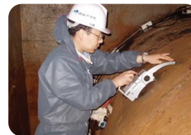
배관외경 측정 : 2000\text{mm} \pm 1\text{mm}
