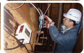
배관외경 측정 : 2000\text{mm} \pm 1\text{mm}
